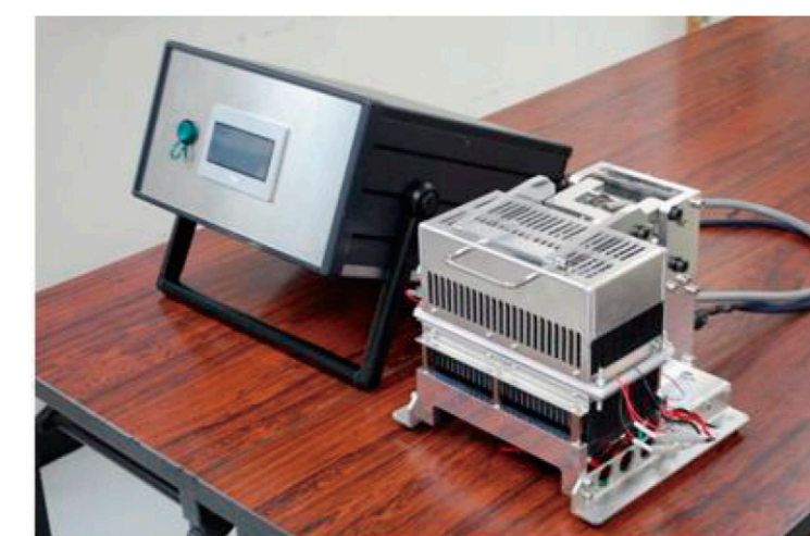
(株)ヤナギヤと共同開発した大容量PCR装置 (特許第6858368号、特願2020-202035、PCT/JP2021-007148)
